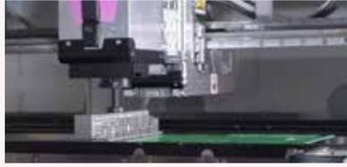
在汽车电子部件、服务器这些产品的电路板上经常用到大型、异形、重型元件。用RH01工作头来贴装这类元件是最理想的选择。支持的最大元件尺寸为200 x 150mm,最大高度为38.1mm,最大搬运重量为350g。
